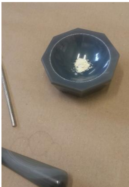
Figura 1. Método de reação de estado sólido, utilizando o almofariz (utensílio para moer pequenas quantidades de produtos)
